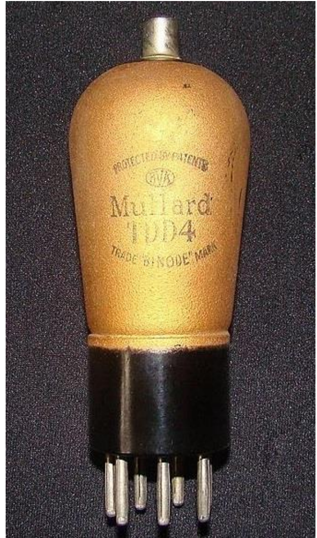
Afbeelding 4: De radiobuizen van Philips en Mullard werden jarenlang van een laag goudverf voorzien om de zwarte aanslag aan de binnenzijde te maskeren.
