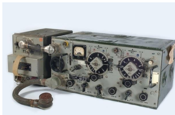
Afbeelding 9: Wireless set voor inbouw in een tank.
