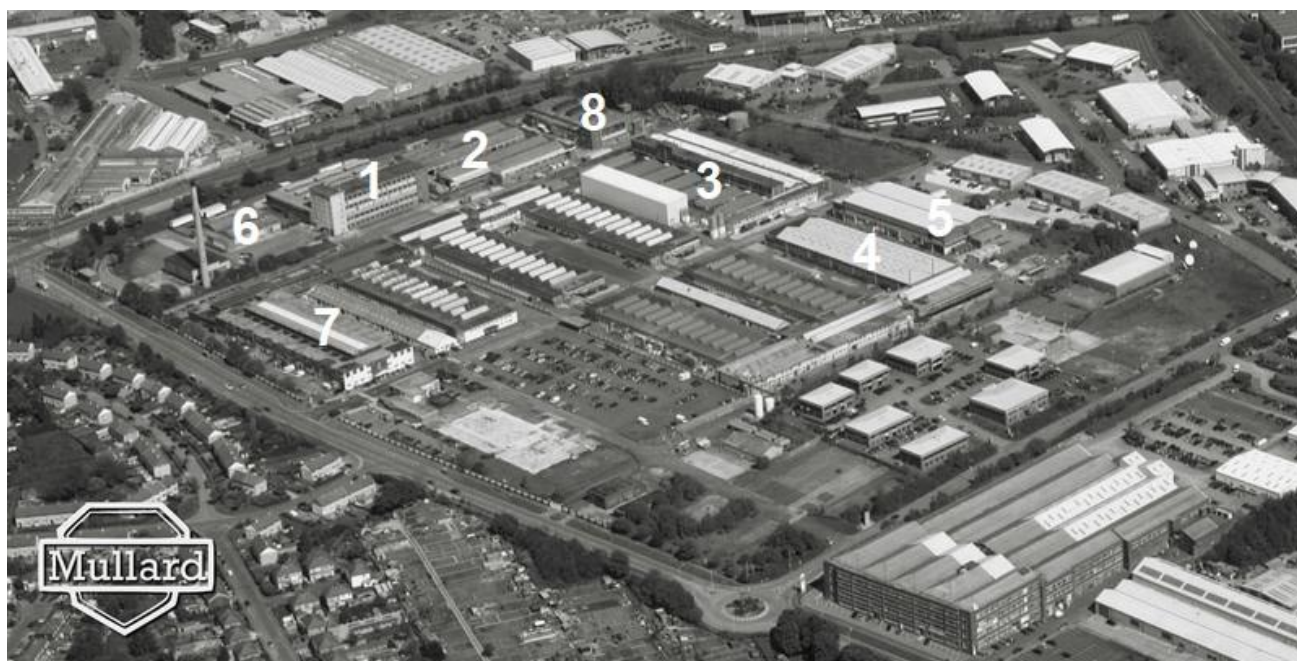
Afbeelding 11: Luchtfoto van Mullard's elektronenbuisfabriek te Blackburn met het kantoorgebouw 'Ribble House' (1), chemical plant (2), glasfabriek (3), draadfabriek (4), assemblagehal (5), gasstation (6), bedrijfsmechanisatie (7) en mengafdeling voor metaalpoeders (8).
