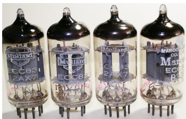
Afbeelding 14: ECC83S-buizen met dubbele kathode.
