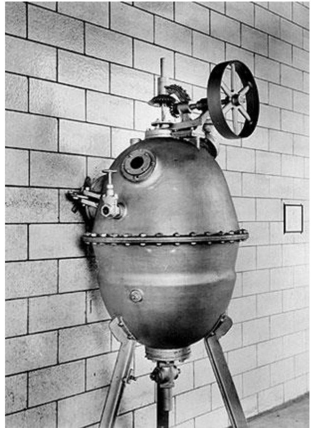
Afbeelding 3: Autoclaafreactor voor kleinschalige productie van bakeliet, ook wel "Bakelizer" genoemd.
