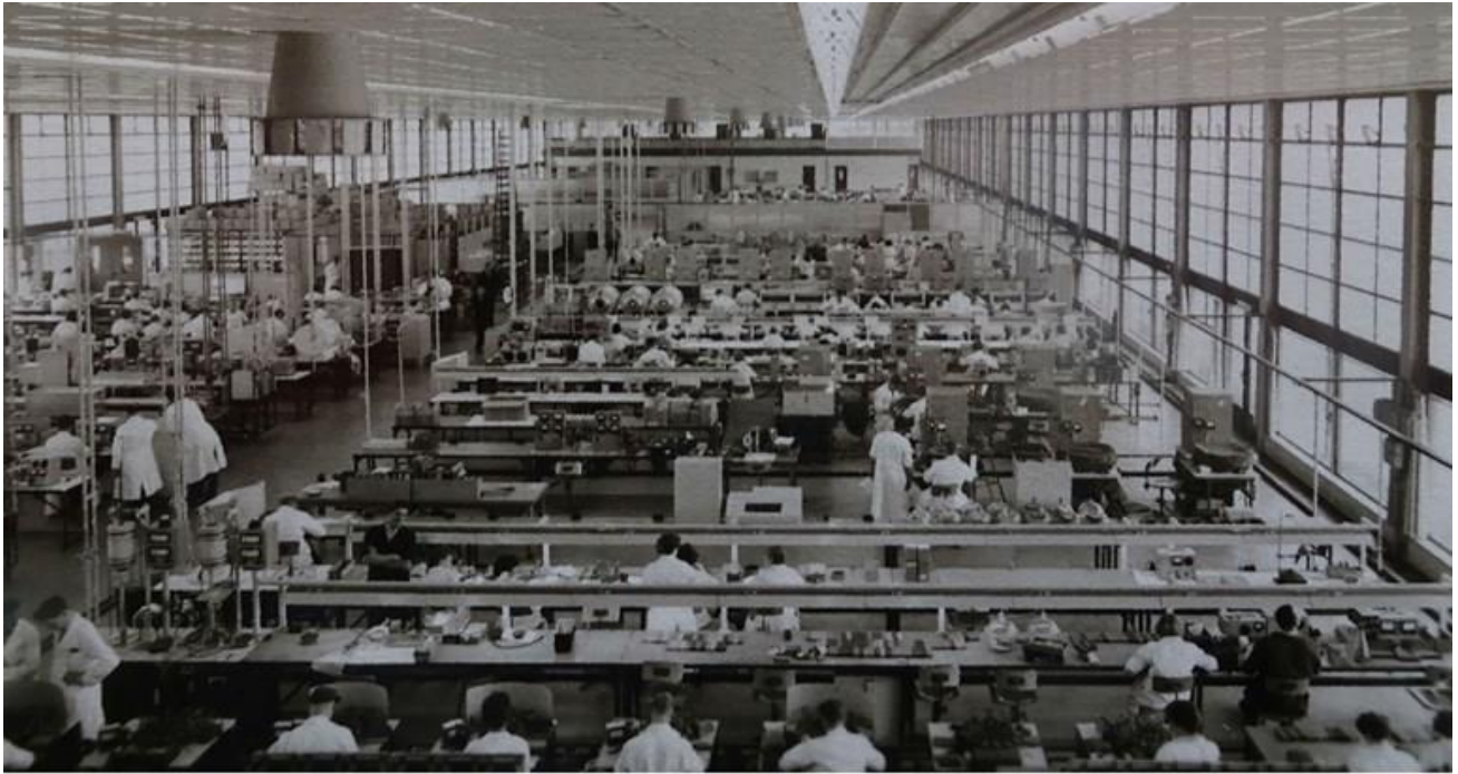
Afbeelding 6: Productie van halfgeleiderdiodes in de eerste grote fabriekshal van het nieuwe bedrijfscomplex.
